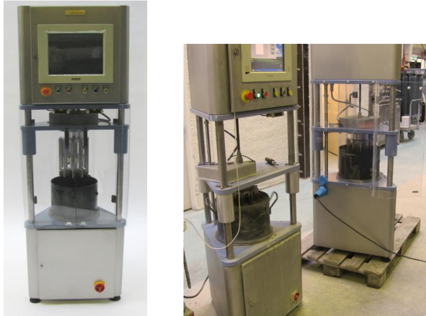
Mynd 12: Seigjumælirinn ConTec Viscometer 5.
