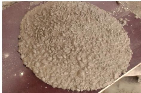
Mynd 15: Mynd af sigmálsflæði af steypunnar eftir blöndun í steypubíl.
