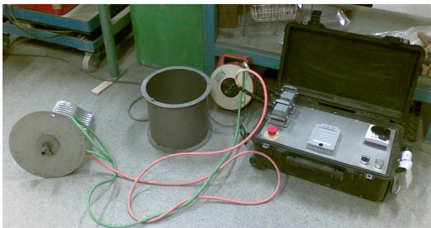
Mynd 13: Mælitækið ConTec Rheometer-4SCC (til vinstri) og Tattersall vispan (til hægri).
